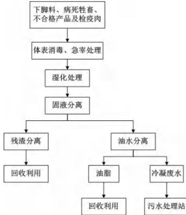
图 3.5.1-2 无害化处理工艺流程图
